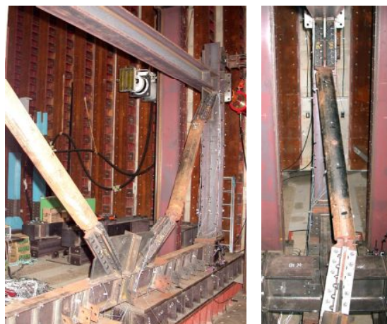
写真1 座屈拘束ブレースの構面外座屈 5)
