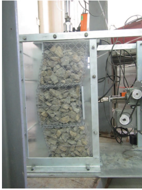
写真5 試験終了時の模型蛇籠擁壁の変形状態
