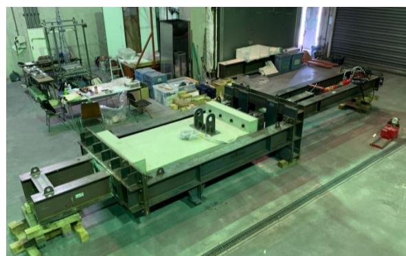
写真1 多目的載荷装置取り付け前の試験体と治具の様子 (2021年2月)
