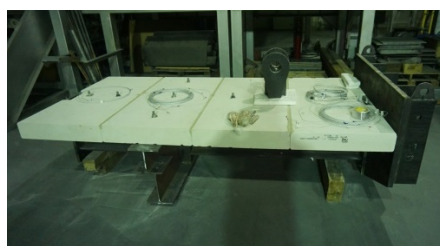
2018年度試験体 (スラブ無し (上部ALC版) )
