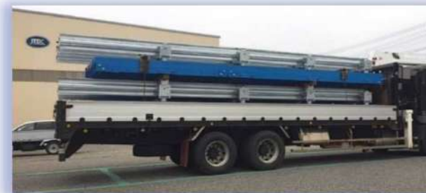
専用ジグ(実用新案:実用第 3232493号)によりビームを取付けた状態で 80m分が大型車両に積載可能 荷卸後、架台とビームを連結するだけでスピーディーに組立完了。
